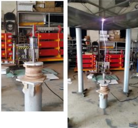
Resim-1/Pic-1 Yıldırım Darbe Test Sistemi ve Erken Emisyon Zaman Kazancı Test Görseli/ESE Test Pic. *PROTART-60/3620
